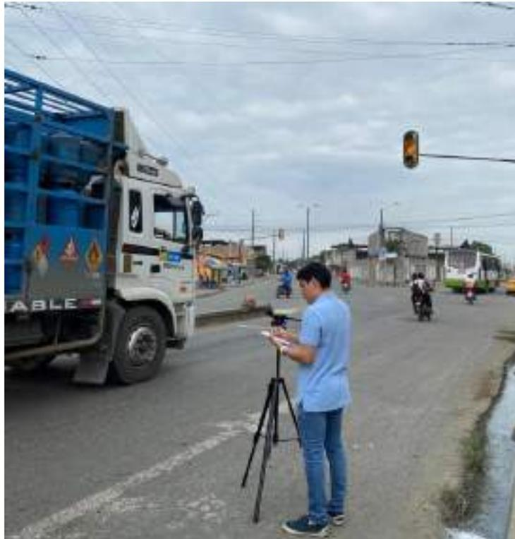
Figura 5. Medición de dB P10 (vespertino)
