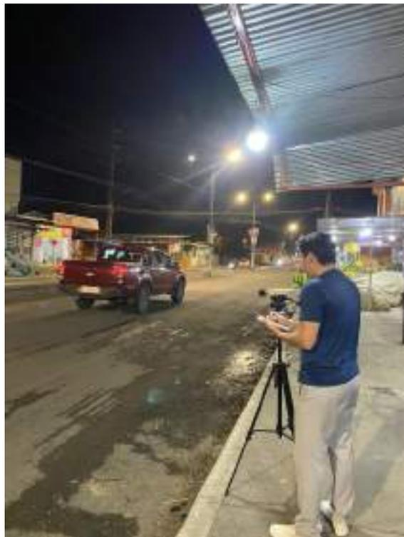
Figura 6. Medición de dB P6 (nocturno)
