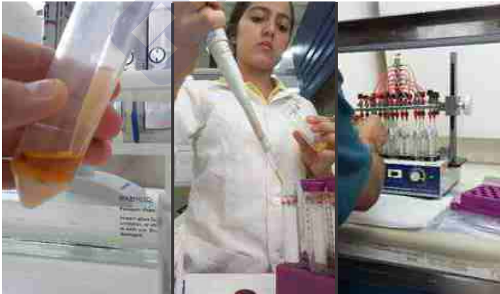
Figura 26. Separación del sobrenadante a otro tubo; llevar a evaporar Andrade, 2022
