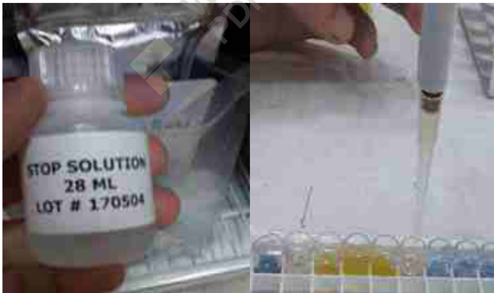
Figura 34. Añadir 100 \mu l de solución de stop a cada pocillo Andrade, 2022
