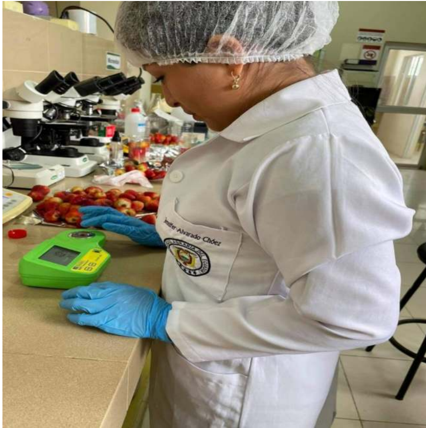
Figura 13. Medición de grados °Brix. Alvarado, 2021
