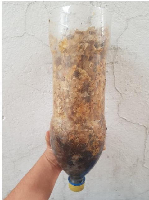
Figura 14. biofiltro con 70% cáscara de camarón y 30% carbón activado Almeida, 2020.
