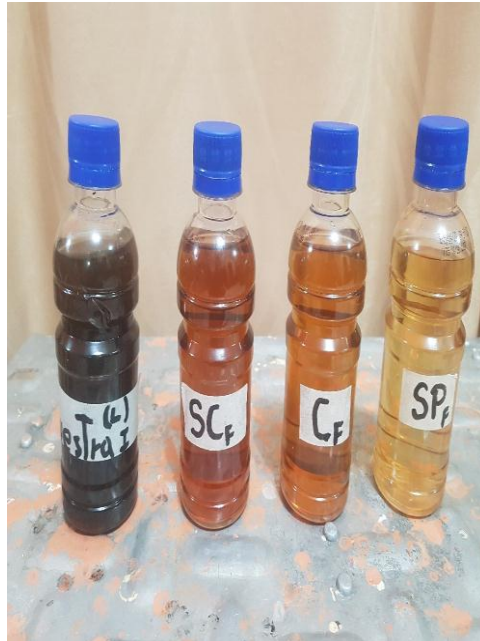
Figura 17. Lixiviado después de la aplicación de los tres biofiltros Almeida, 2020.
