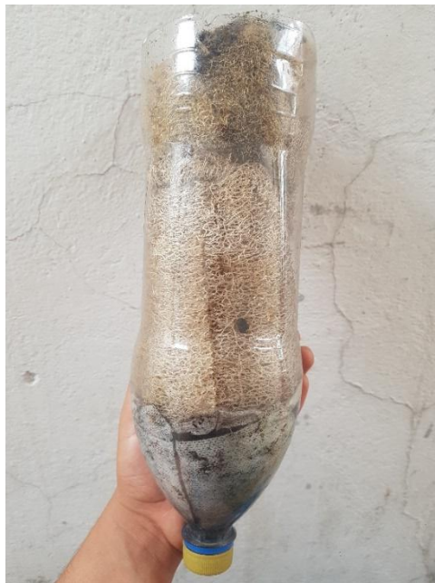
Figura 12. biofiltro con 70% luffa y 30% carbón activado Almeida, 2020.
