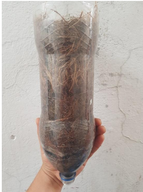
Figura 13. biofiltro con 70% fibra de coco y 30% carbón activado Almeida, 2020.
