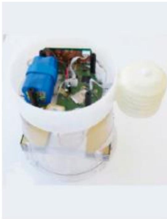
Figura 5. Trampa McPhail equipada con lente de Fresnel
