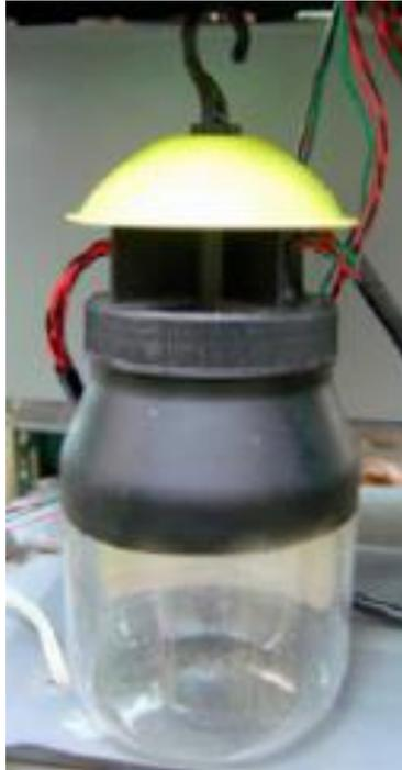
Figura 6. Trampa automática con sensor de infrarrojos para *Bactrocera dorsalis*
