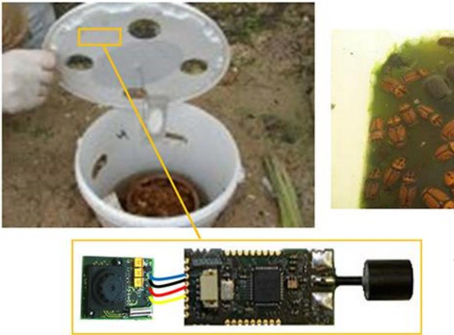
Figura 1. Trampa con sensor, imagen del contenido de la trampa y sensor inalámbrico de imagen
