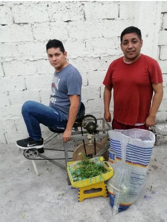
Figura 22. Prueba mecánica de molino de desechos orgánicos
